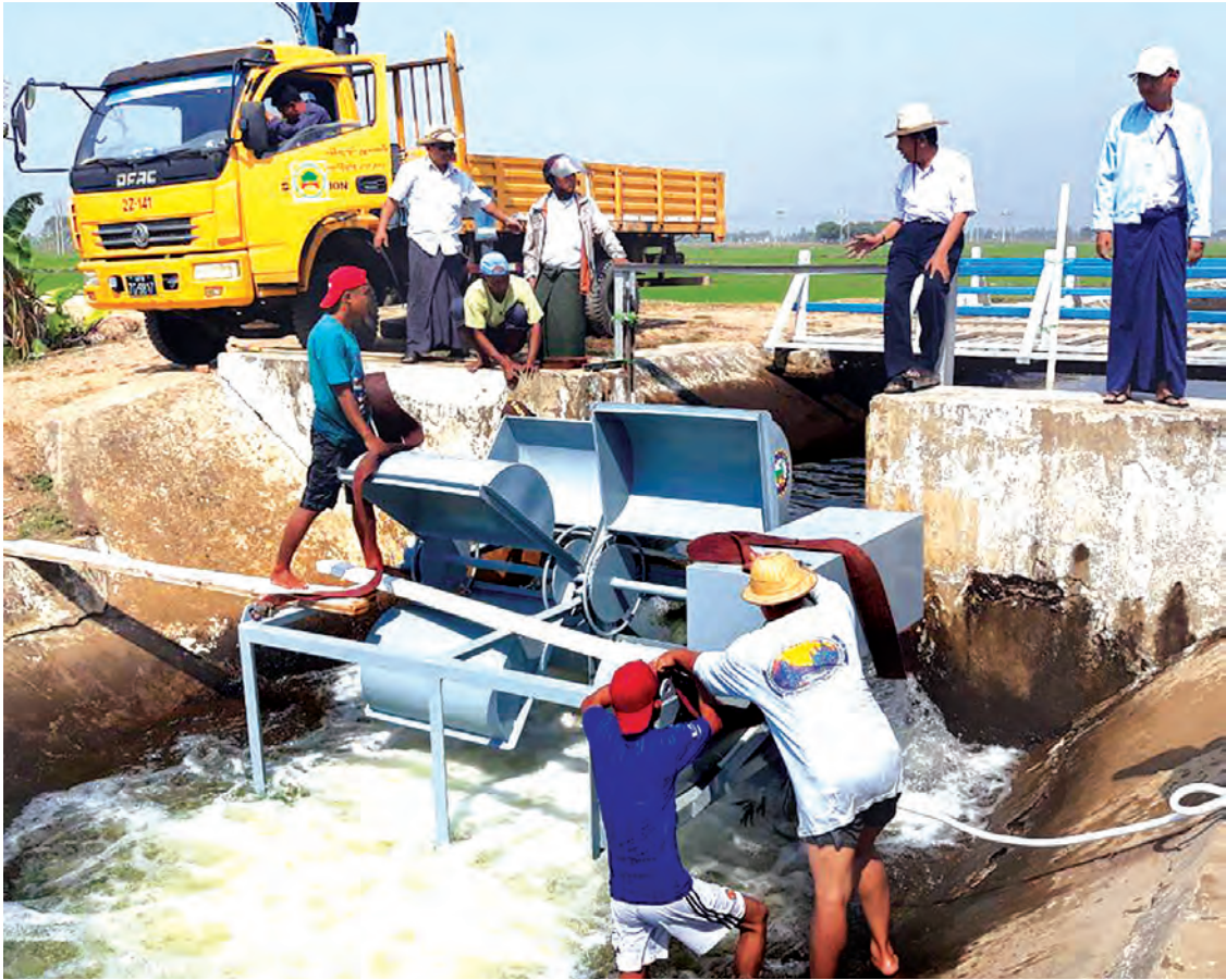
လျှပ်စစ်မီးရရှိရန် ခက်ခဲသော ဒေသများတွင်အသုံးပြုရန်နှင့် ဖွံ့ဖြိုးဆဲပြည်ပနိုင်ငံများသို့ ရောင်းချနိုင်ရန်အတွက် Mini Hydro Turbine ကို ရေဆင်းဆည်ရှိ ဆည်ရေသောက်တူးမြောင်းအတွင်း စမ်းသပ်ဆောင်ရွက်နေသည်ကို တွေ့ရစဉ်။
