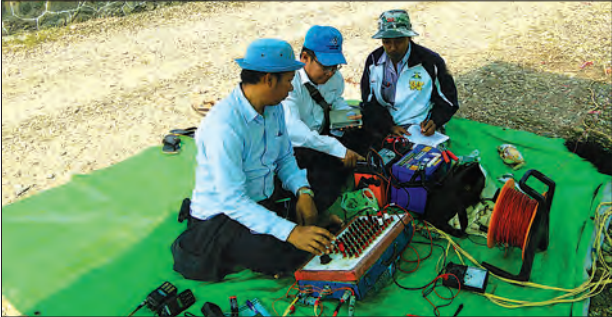
ဖြူးတမံတွင် ဘူမိရုပ်အသွင် ပုံရိပ်ဖော်စက်များနှင့် ခေတ်မီ နည်းပညာများ အသုံးပြု၍ အသေးစိတ်တိုင်းတာမှုများ ပြုလုပ်စဉ်။
