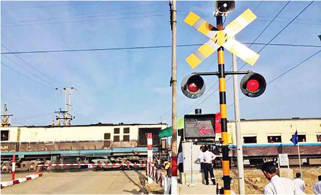
ရန်ကုန်မြို့ပတ်ရထားလမ်းတစ်လျှောက် ရထားလမ်းနှင့် ကားလမ်းဆုံရာ တရားဝင်ဖြတ်ကူးဂိတ်တွင် အလိုအလျောက်စနစ် အသုံးပြုစဉ်။
